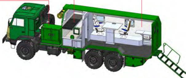
Агрегатный модуль 1400×2450×1520-2150 мм Жилая зона 1330×2350×2050 мм Рабочая зона 4500×2350×2050 мм
