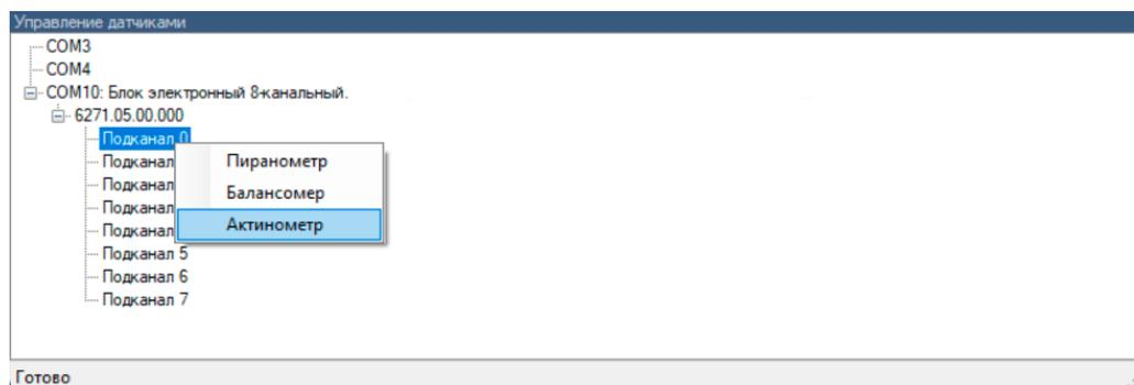
Рисунок 1.24 – Окно управление датчиками (подключение датчика)
