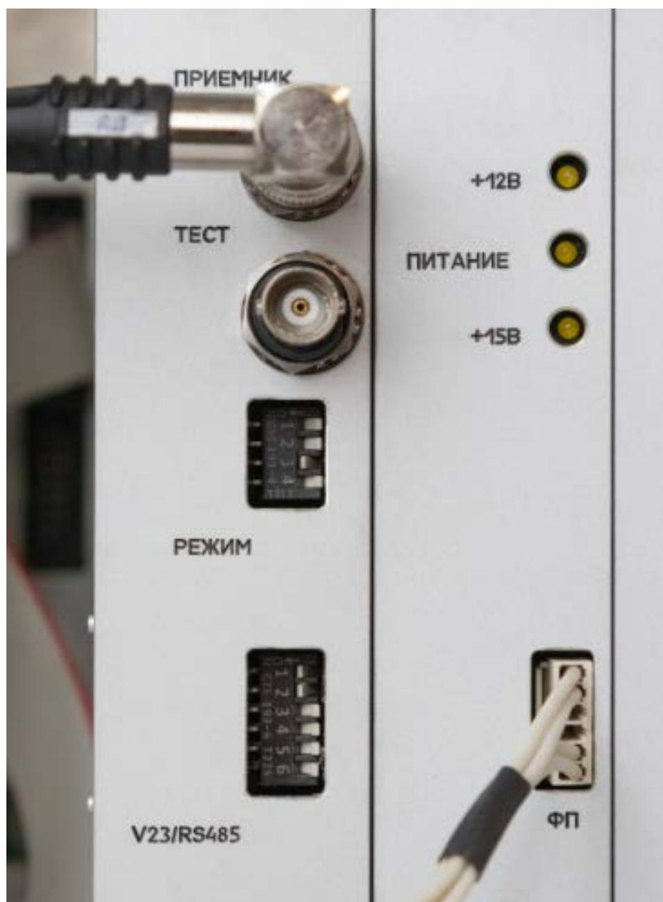
**Рисунок 2.11 – Режим управление с ПК по интерфейсу RS-485-4W**
