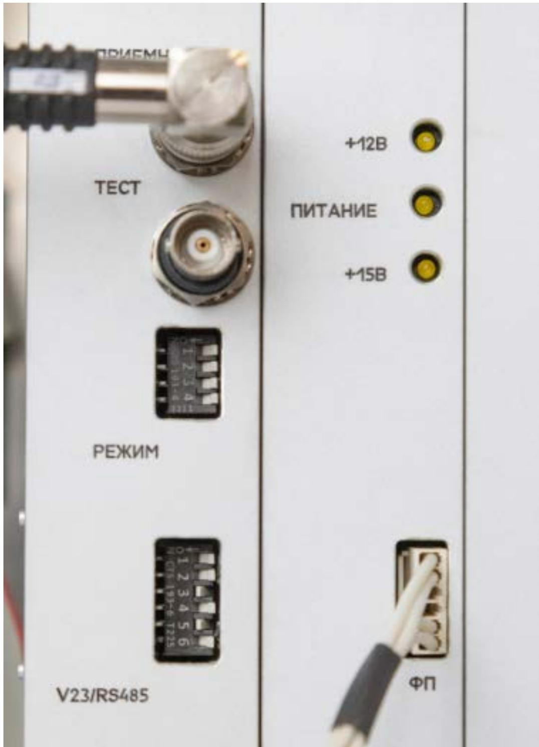
Рисунок 2.12 – Автономный режим по интерфейсу RS-485-2W
