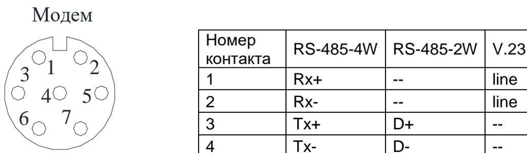
**Рисунок 2.19 – Схема подключения разъёма МОДЕМ**
