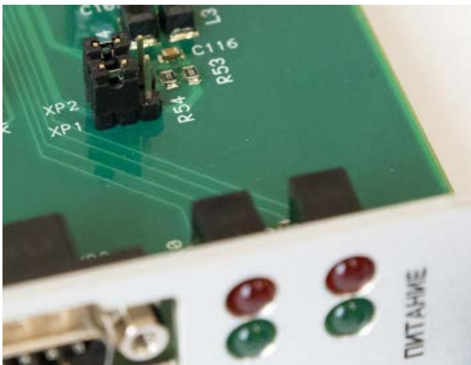
**Рисунок 2.15 – Джамперы на плате управления для интерфейсов RS-485-4W и RS-485-2W**
