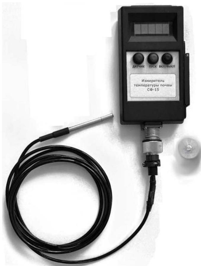
Рисунок 1 – Измеритель температуры почвы СФ – 15. Общий вид
