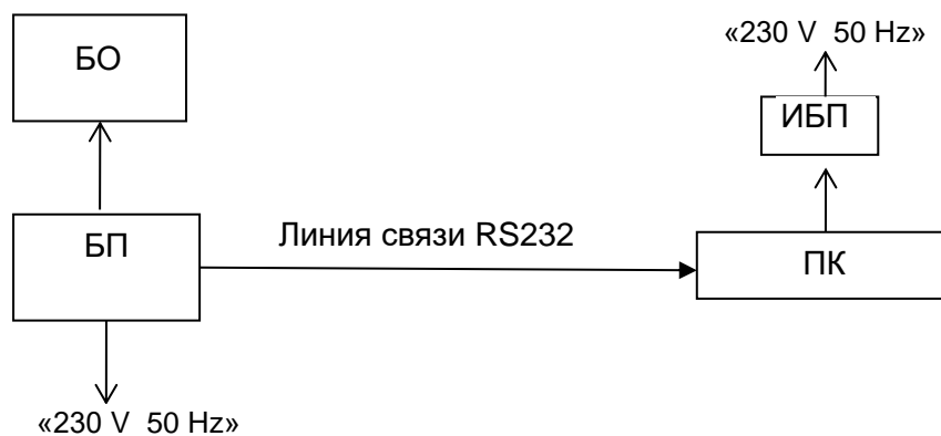
Рисунок 1.9 – Схема электрическая соединений прибора с ПК по интерфейсу RS232
