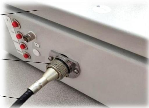
Рисунок 2.2 – Присоединение вала гибкого к блоку электроники
