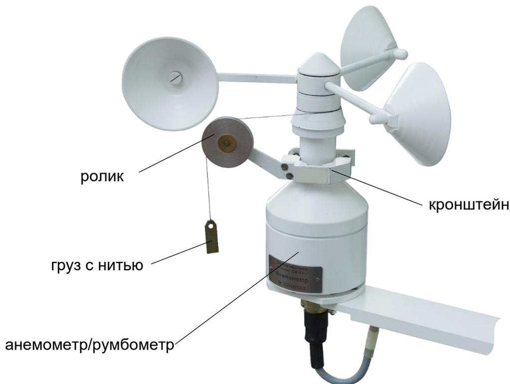
Рисунок 2.11 – Установка приспособления для проверки момента трения
