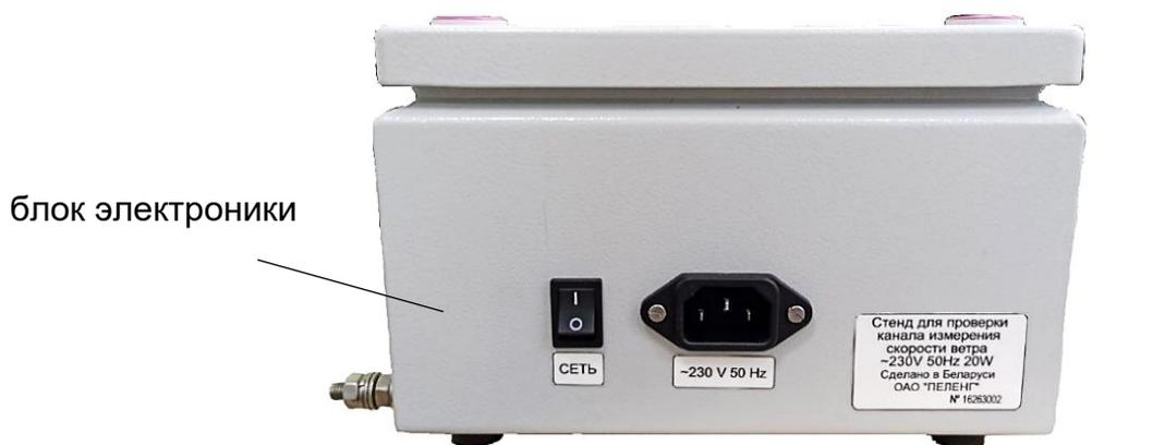
**Рисунок 1.5 – Выключатель СЕТЬ и вилка «~230V 50Hz»**
